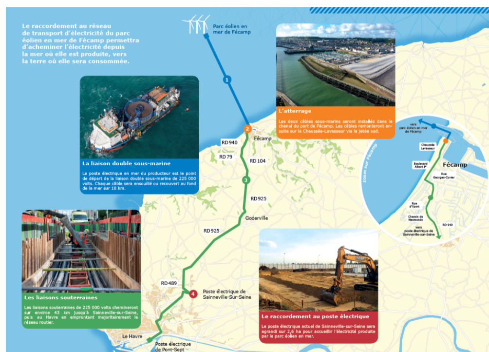
Les différentes étapes des travaux pour le parc éolien en mer de Fécamp
